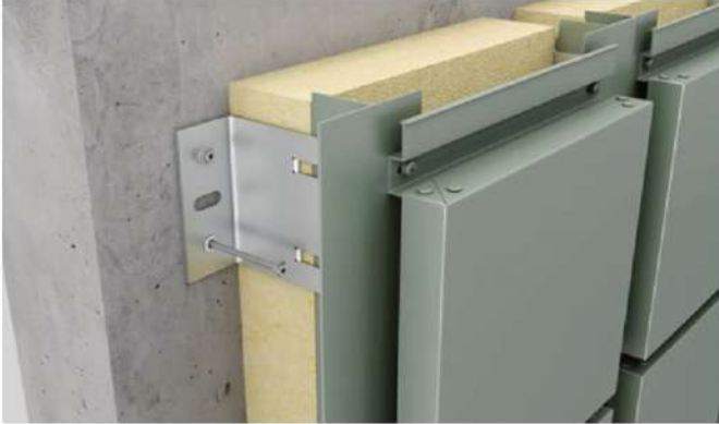
Montaż fasad wentylowanych
