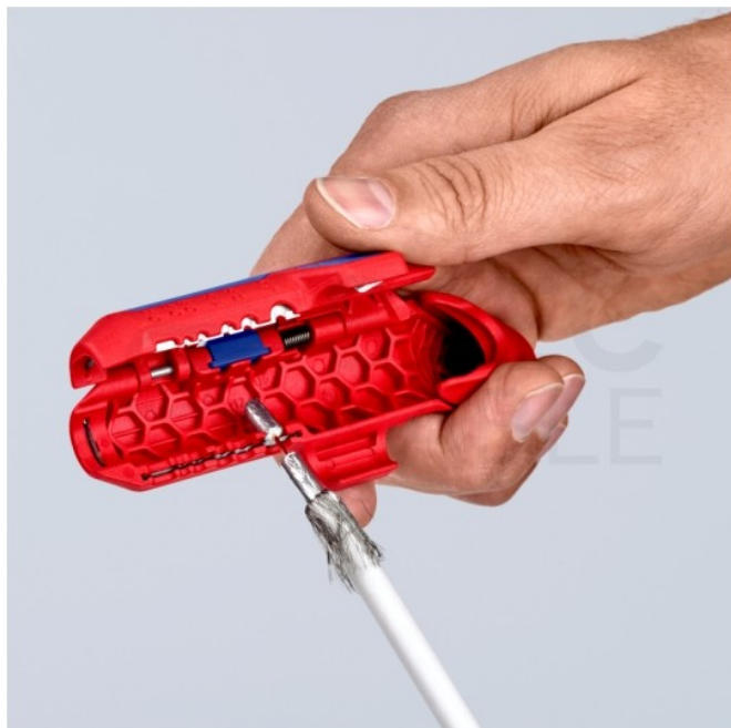
6) Ściąganie izolacji z pojedynczych przewodów.
