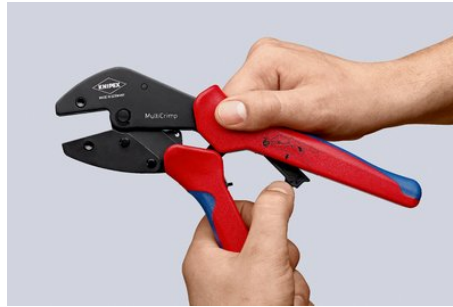
Przygotowanie do wymiany: rozłożyć dźwignię serwisową, dzięki czemu szczęki ustawią się równolegle
