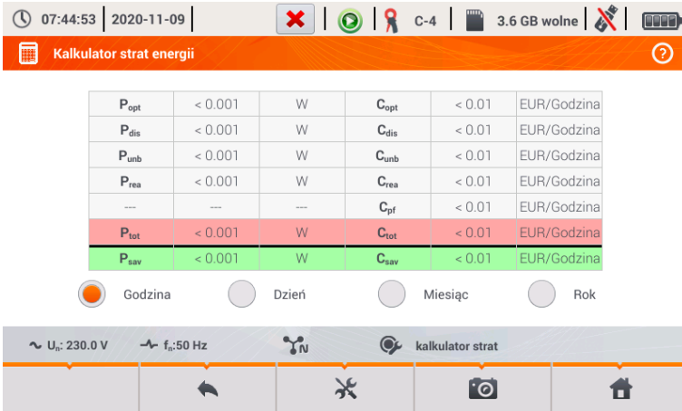
Rys. 49. Analiza strat energii
