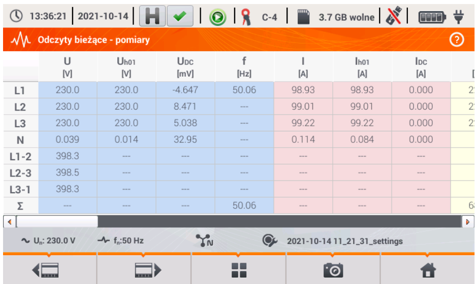
Rys. 54. Odczyty bieżące - pomiar.
