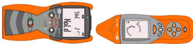
Rys. 5 Ułożenie nadajnika i odbiornika podczas synchronizacji
