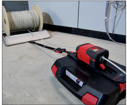
RM35 mit PRO 530 und 5 x 2,5 mm 2 Kabel RM35 with PRO 530 and 5 x 2,5 mm 2 Cable
