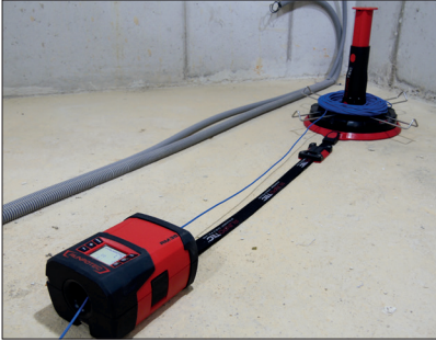
RM35 mit XB 300 und Multifunktionsdorn mit Einzelader RM35 with XB 300 and multi-function mandrel with individual wires
