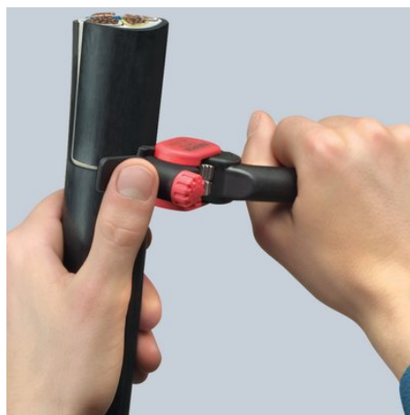
Cięcie po obwodzie
