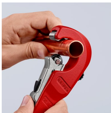
Za pomocą mechanizmu szybkiej regulacji jedną ręką sprężysty krążek tnący może być dosuwany do średnicy rury. Krążek tnący z mechanizmem szybkiej regulacji QuickLock dosuń do rury: szybkie dopasowanie do rur o różnych średnicach ...
