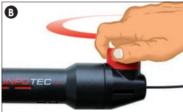
Herða skal klemmugrip með því að snúa því réttshlæis. Festa skal grommin á öxlinum.
