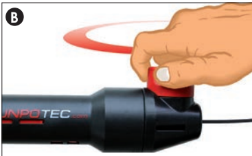
B Girar hasta trabar el asa de fijación. La espiral queda axialmente fija.
