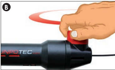
B Затянуть зажимную рукоятку по часовой стрелке. Спираль фиксируется в осевом направлении.
